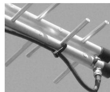
A conexão do cabo na antena
